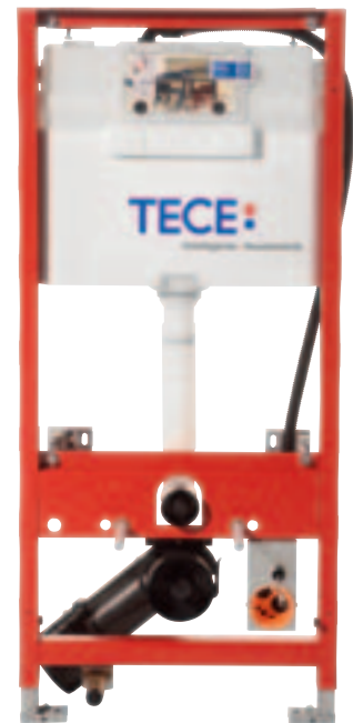
TECEprofil-WC-Modul für TOTO-Neorest-Dusch-WC Die Fernauslösung ist über das Dusch-WC möglich. Mit Steuerkabel für die elektronische Spülauslösung, Hohlwandgerätedose und schallentkoppelter Wandscheibe. Best.-Nr. 9.300.044
